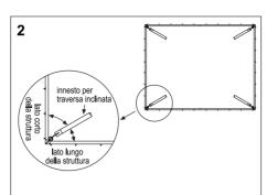
Per le strutture rettangolari, posizionare i giunti angolari facendo attenzione che l'innesto per collegare la traversa inclinata sia rivolto verso il lato lungo della struttura.
